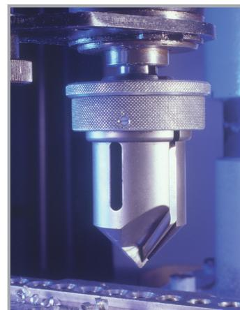
L'Appareil à Chanfreiner KOPAL, s'utilise sur Machine à chanfreiner ou Perceuse à colonne à avance manuel.
